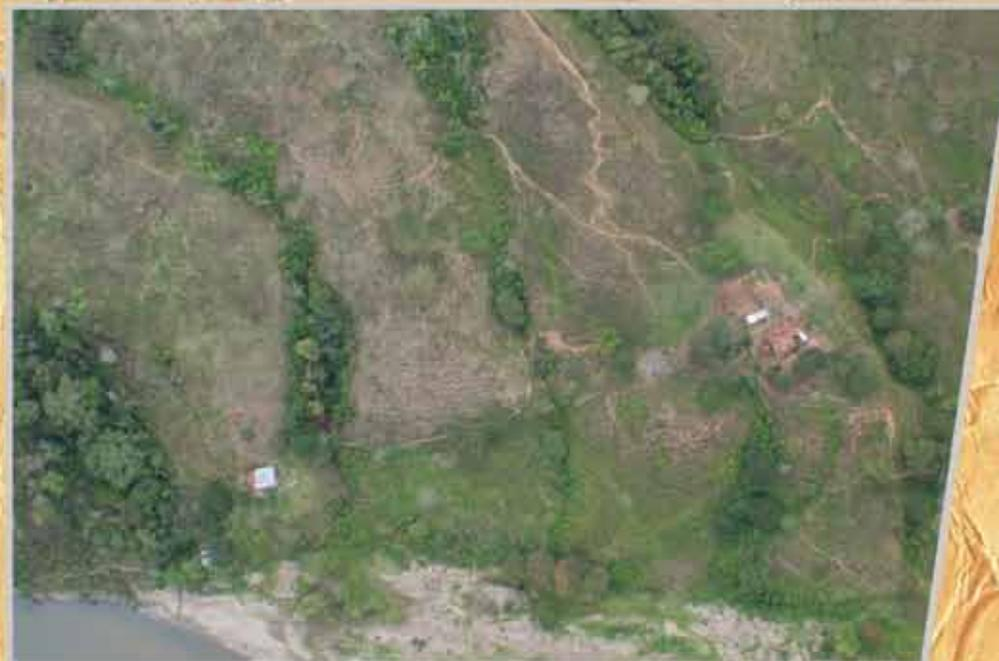
Imagen 27. Areas con fuertes problemas de erosión y escorrentía superficial hacia los cursos de agua, causando problemas de sedimentación y contaminación, localizadas en el extremo sur-Honduras del río Coco.
