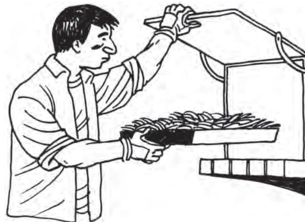
Secado de materia verde en horno para la obtención de valores de materia seca.
